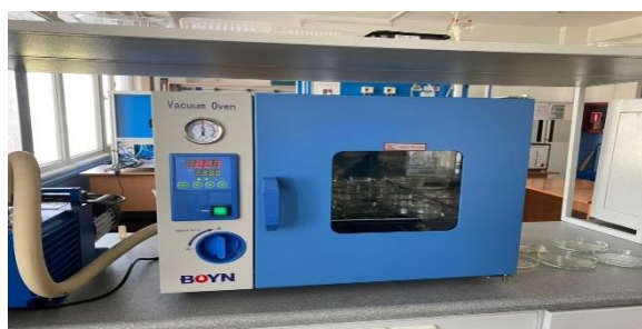
Рисунок 2 – Электрическая лабораторная вакуумная сушильная печь с цифровым дисплеем NBD-6050
